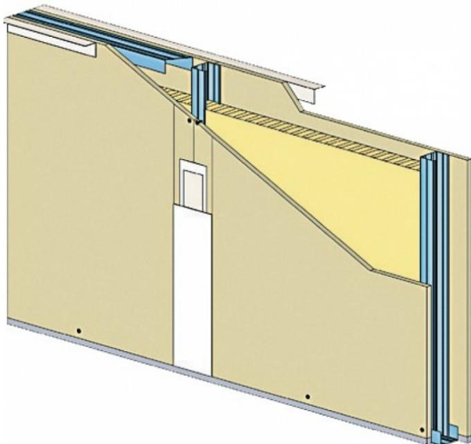
Cloison distributive constituée d'un réseau d'ossature en montants simples ou doubles selon la hauteur de l'ouvrage et d'un parement simple en plaques Knauf KHD 18/900.
